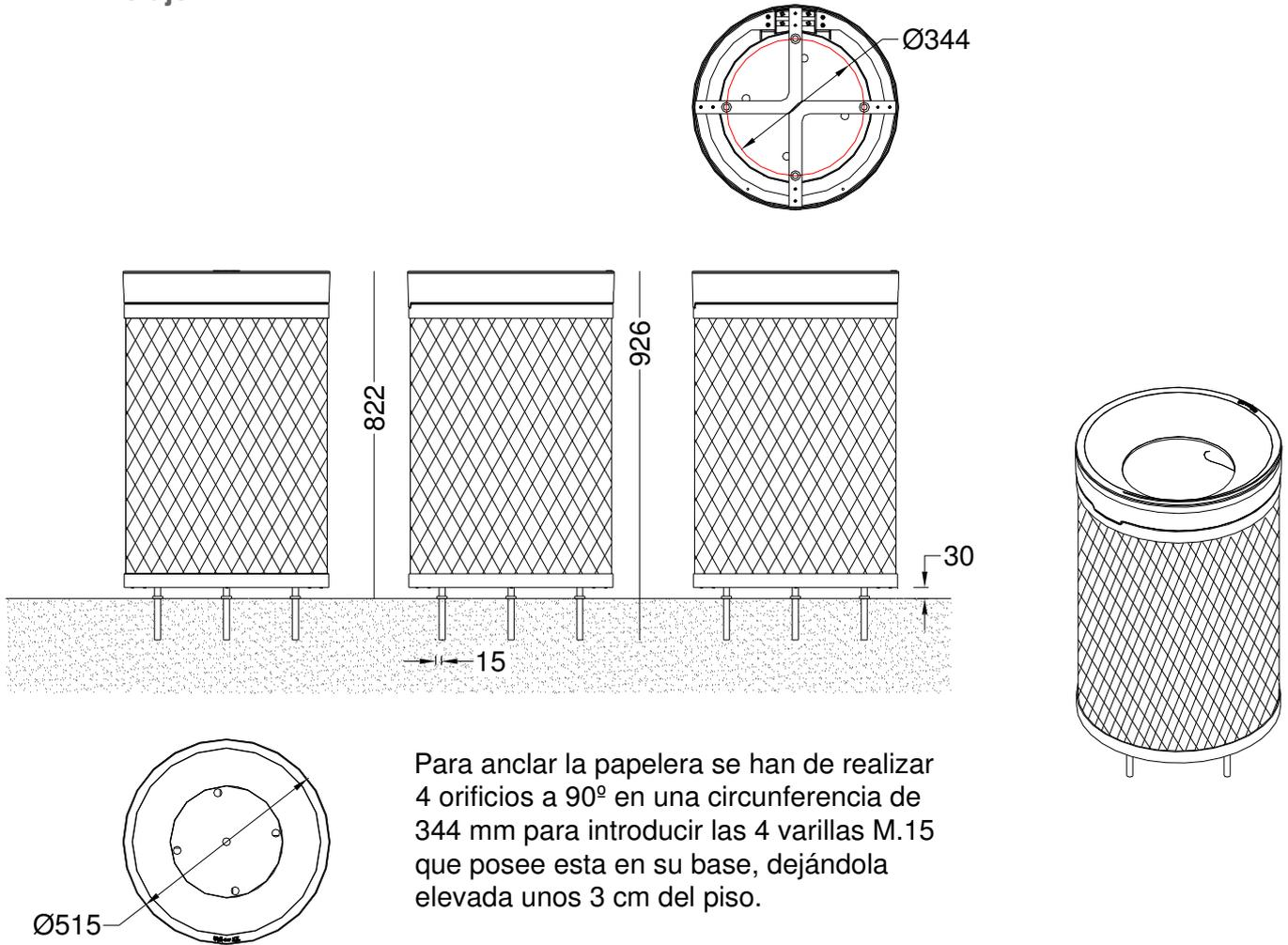
Para anclar la papelera se han de realizar 4 orificios a 90° en una circunferencia de 344 mm para introducir las 4 varillas M.15 que posee esta en su base, dejándola elevada unos 3 cm del piso.
