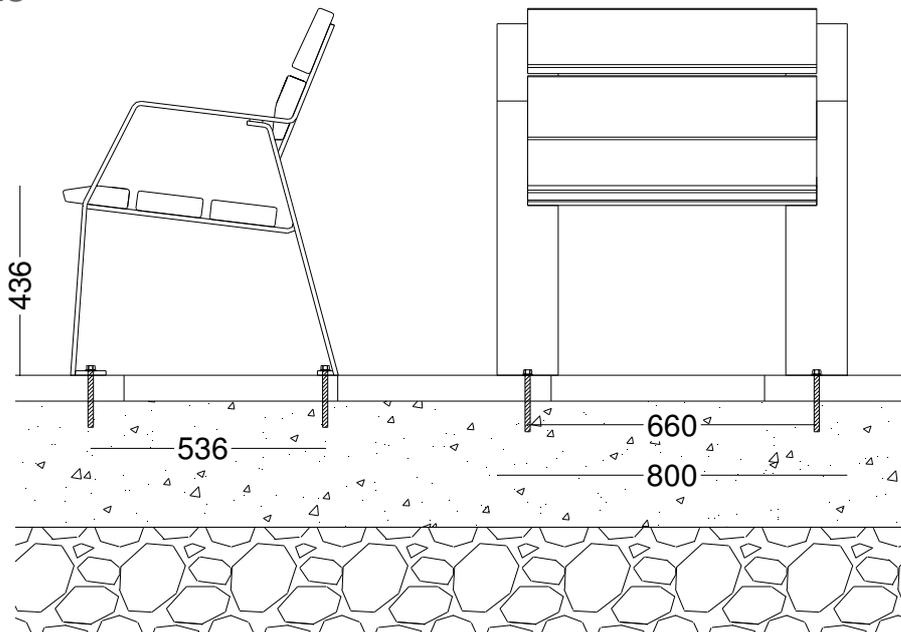
Anclaje a suelo mediante cuatro tacos de expansión MTA M.12 ó similar y longitud adecuada al piso.
