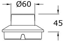
Detalle del adaptador a luminaria x5
